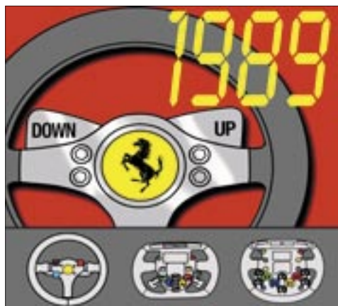
GP del Brasile: debutto vincente della F1-89 dotata dell'innovativo cambio elettroidraulico con comando al volante che sarà copiato da tutti i costruttori
